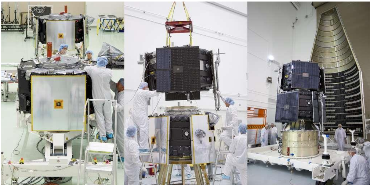
Les deux satellites identiques de la mission RBSP. Sur l'image de droite, ils sont en cours d'intégration dans la coiffe du lanceur. © Nasa
