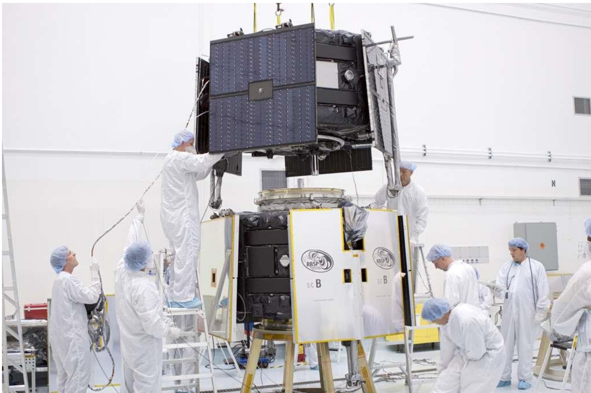
Installation, l'une sur l'autre, des deux sondes de la mission RSBP pour être intégrées dans le lanceur. © Nasa
